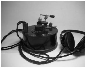
Kristallmottagare från 1925. Apparaten behöver ingen ström!
